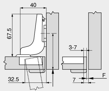
Расстояние (от края) до места крепления ответной планки увеличивается на толщину фасада FD +1.5 мм
